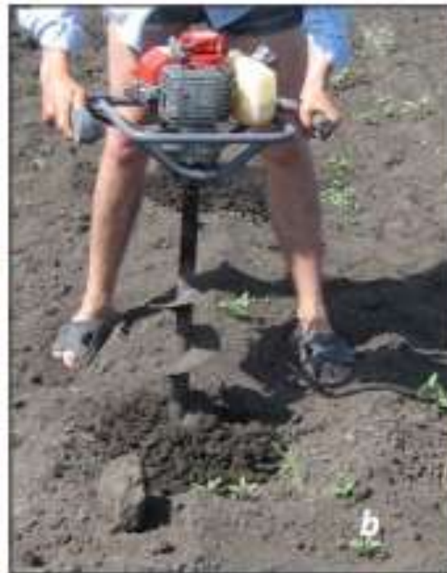
Săparea gropilor: a. – cu agregatul SG-1; b. - motoburghiul; c. – aspectul gropilor efectuate mecanizat.
